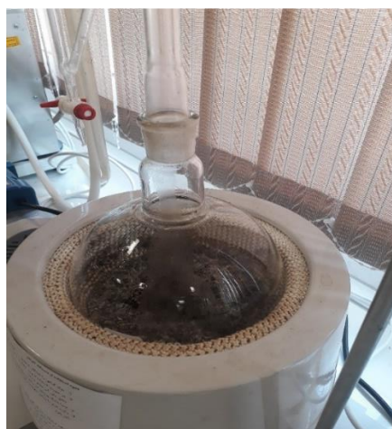
شکل ۱- اسانس‌گیری مریم‌گلی با دستگاه کلونجر
