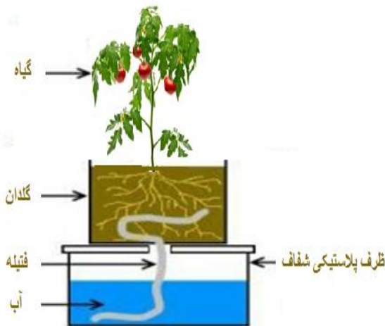
شکل ۱- شماتیک سامانه آبیاری فتیله‌ای
