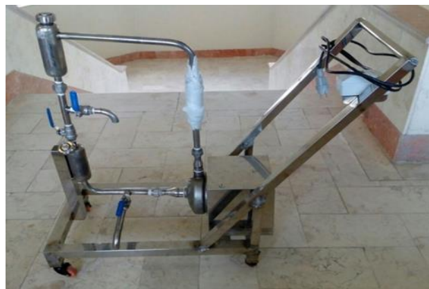
شکل ۱- دستگاه مغناطیس کننده آب (راست) و نحوه کارکرد آن (چپ)
