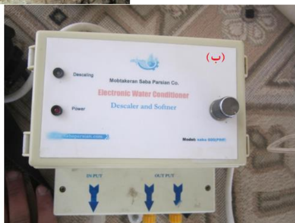
شکل ۲- دستگاه مغناطیس (الف) و الکترومغناطیس (ب) نصب شده بر روی لوله
