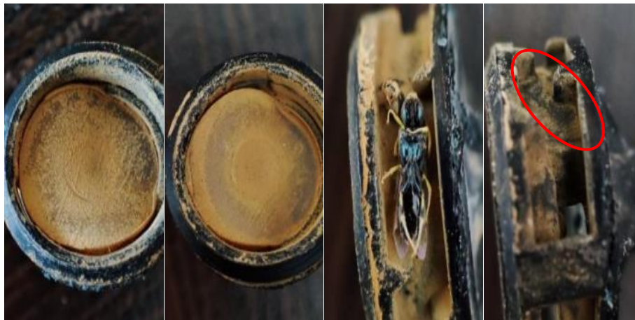
شکل ۶- تصاویری از چسبیدگی دیافراگم در قطره‌چکان‌های نتافیم هشت لیتر در ساعت و ورود حشرات از مجرای خروجی که منجر به انسداد مسیر عبور آب شده‌اند
