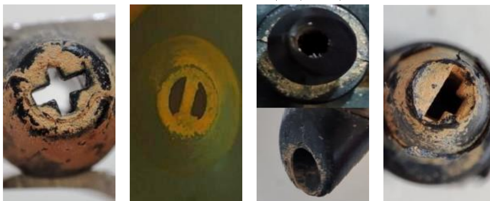
شکل ۱۲- ساختار مجرای ورود آب و میزان ورود اجسام خارجی ریز به سطح زیر دیافراگم درون قطره‌چکان در نمونه‌های مختلف
