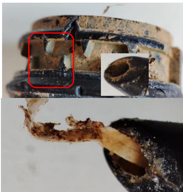
شکل ۹- شکل مجرای ورودی آب در قطره‌چکان پرسی زالوان هشت لیتر در ساعت و ورود اجسام خارجی و در نتیجه انسداد مجرای عبور آب در فشارهای ۰/۵ و ۲/۵ بار
