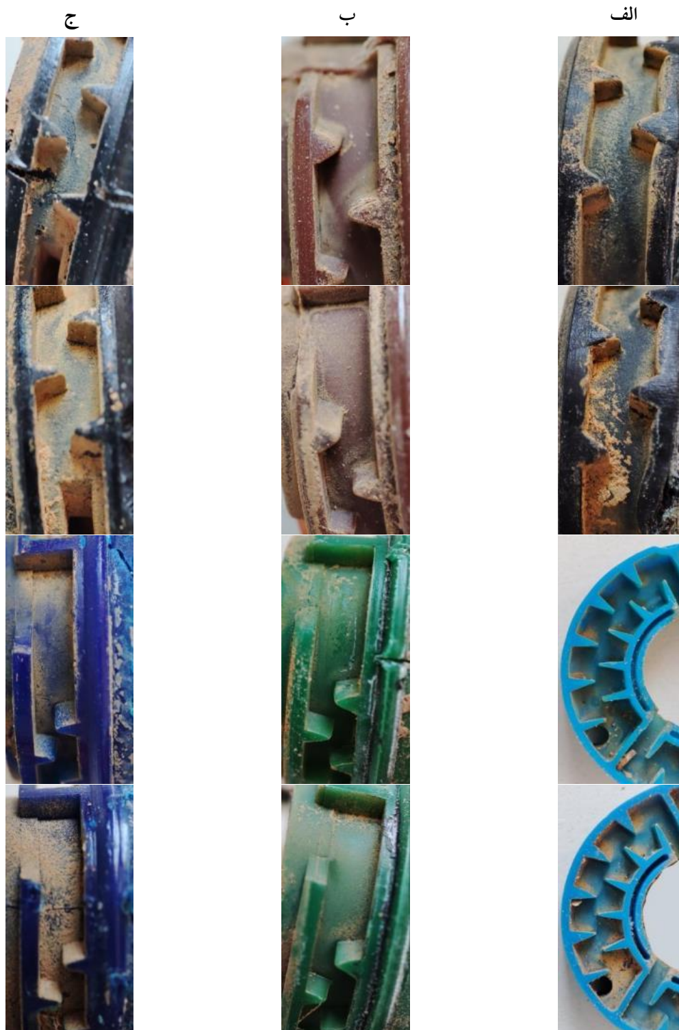
شکل ۴- مقایسه وضعیت رسوب ذرات جامد در مجرای عبور آب در قطره‌چکان‌های ۸ (بالا) و ۲۴ (پایین) لیتر در ساعت به ترتیب در شرایط کاربرد شورهای ۵ (سمت راست) و ۱۲ (سمت چپ) دسی زیمنس بر متر. الف: نتافیم، ب: یوروردریپ و ج: بررسی زالوان
