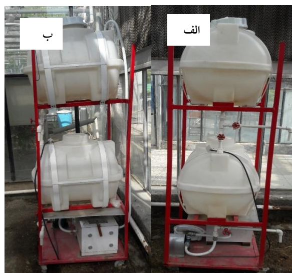
شکل ۳- الف) نمای جانب سیستم مغناطیس کننده سیالات ب) نمای روبروی سیستم مغناطیس کننده سیالات
