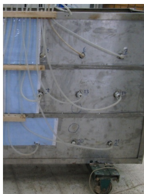
شکل ۲- نمایی از لوله‌های پیرومتر
